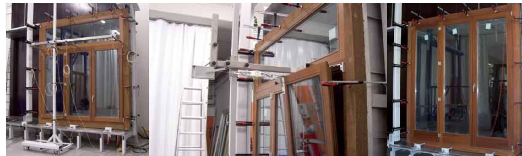
TEST DI RESISTENZA AL CARICO DI VENTO, DETERMINAZIONE DELLA RESISTENZA ALLA TORSIONE STATICA, TEST DI TENUTA ALL'ACQUA
